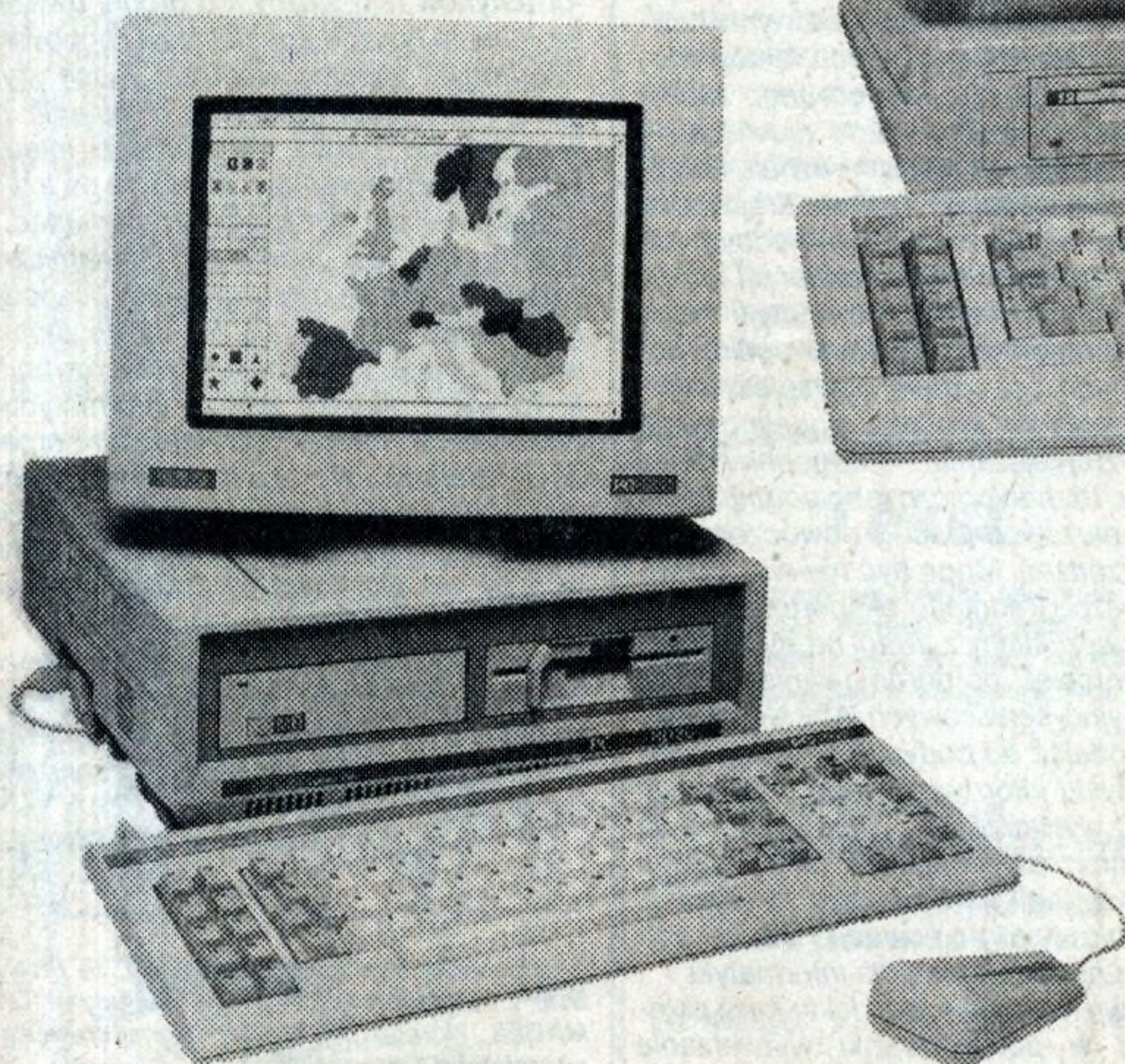
AMSTRAD 1640 RAM — 640 KB Mikroprocesor 8086 (8 Mhz) EGA, Hercules, MDA lub CGA
