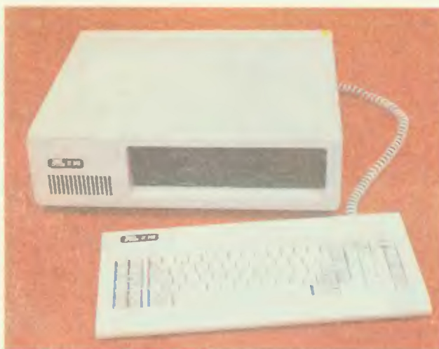
Komputer kompatybilny z IBM-PC rodem z Tajwanu w konfiguracji minimalnej. Naśladownictwo posunęło nawet do obudowy i do układu klawiatury
