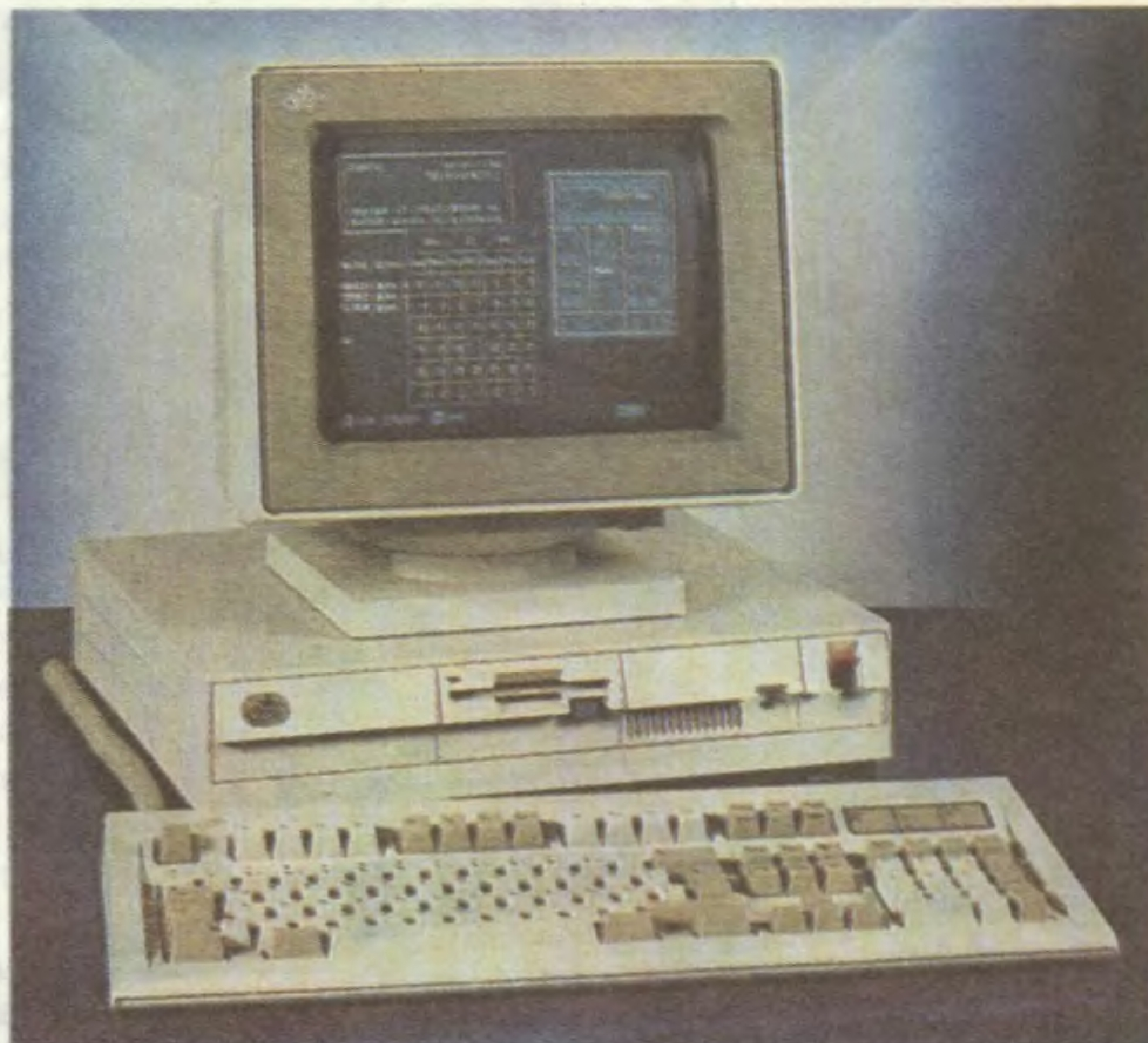
Najmniejszy członek rodziny PS 2 — tutaj w konfiguracji z jednym dyskiem elastycznym i dyskiem twardym 20 MB oraz z monitorem monochromatycznym (na ekranie: SideKick)
