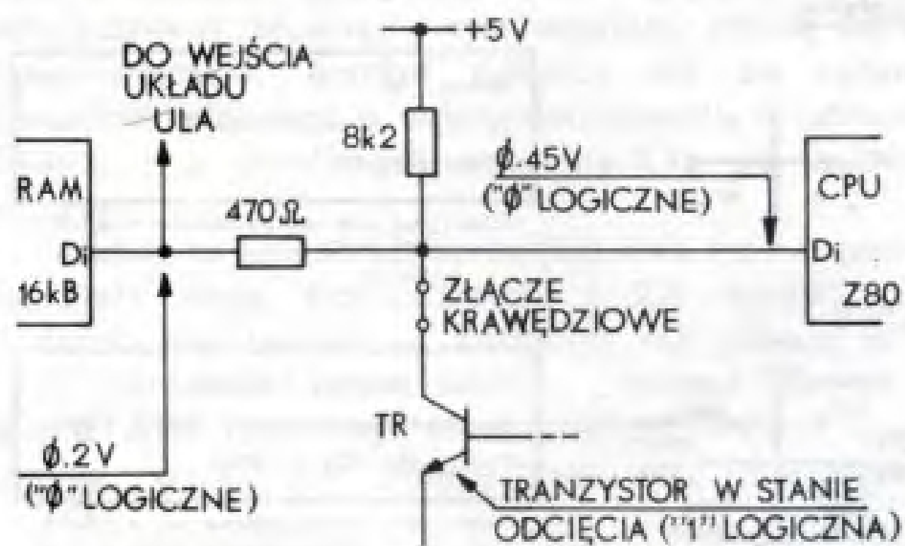
Rys. 4. Rozkład napięć przy niekorzystnym przypadku współpracy interfejsu z komputerem
