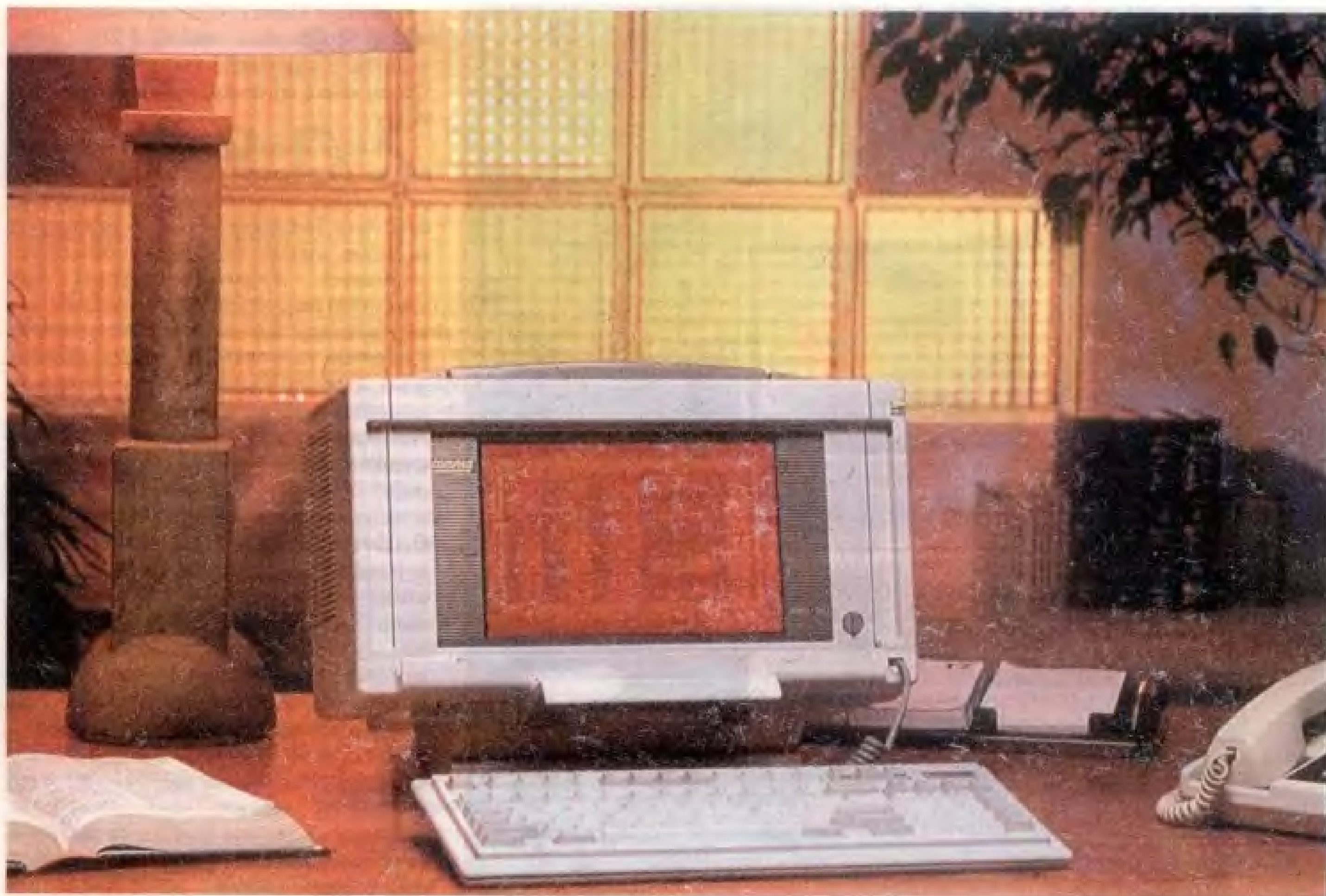
Compaq Portable 386 — ta przenośna maszyna o masie zaledwie 9 kg przewyższa swoją wydajnością niejedną znacznie większą komputer klasy IBM PC/AT
