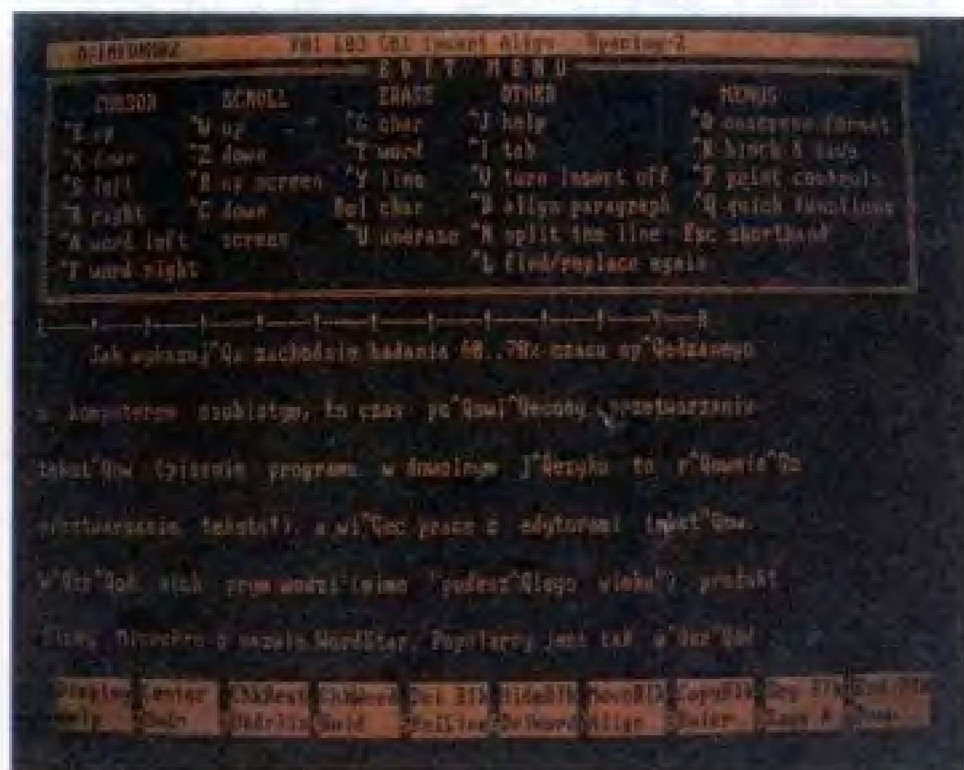
WordStar wersja 4.00 — fragment tekstu z ukrytymi znakami kontrolnymi (polecenie ^OD)
